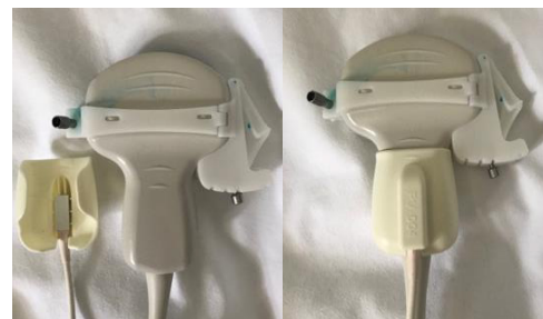
Изображение 2 Магнитный сенсор закреплён на ультразвуковом датчике
